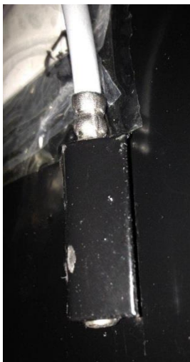
Fixation d'une sonde, plaquette frappée au marteau
