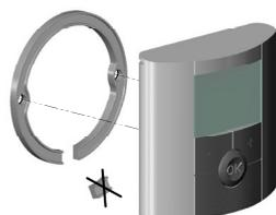
L'interférence peut se produire si l'antenne est placée sur le métal, les tuyauteries en métal, trop près d'autres appareils sans fil ou des câbles. L'antenne ne peut pas être située trop près de l'unité d'ambiance pendant le démarrage.
