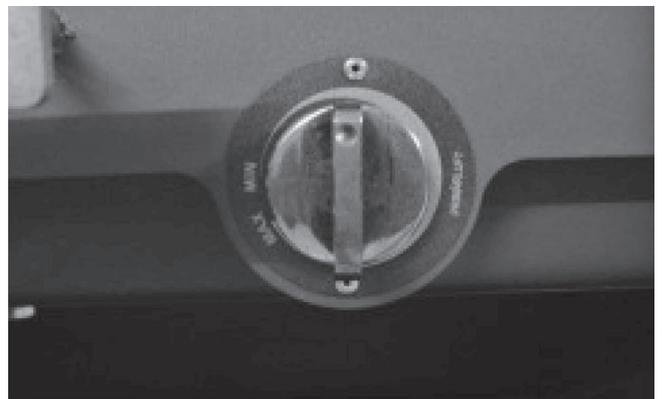
Régulateur automatique en position «12h». L'arrivée d'air primaire se referme automatiquement après la phase d'allumage).
