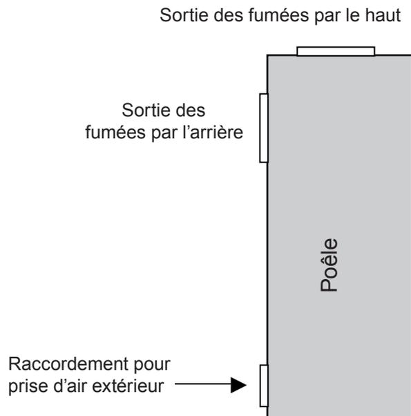
Dans le cas de pièces à vivre particulièrement étanches, il est possible de raccorder le poêle à une prise d'air extérieur.
