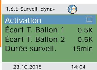
Lorsqu'elle est activée, l'option ›Surveil. dynamique‹ contrôle les écarts de température pendant la durée définie dans ›Durée surveil.‹.
