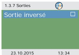
La fonction ›Sortie inversé‹ inverse l'activation/la désactivation des vannes, par exemple si l'installation d'une vanne n'est pas conforme aux normes.
