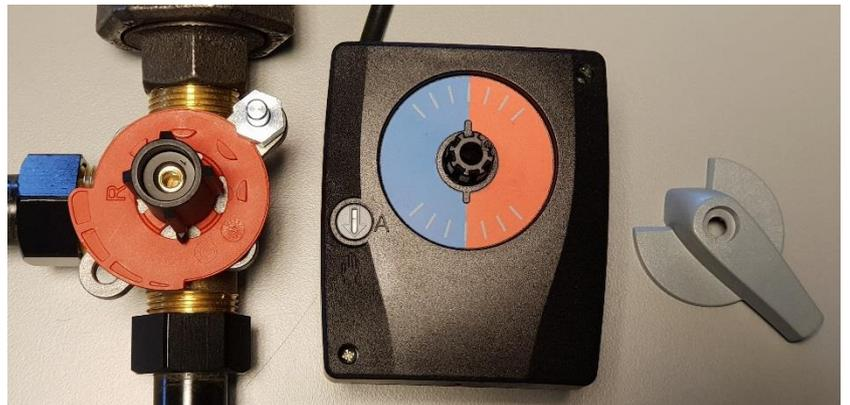
Débrayer le moteur de vanne en position manuelle à l'aide d'un tournevis plat (appuyer et tourner sans forcer)
